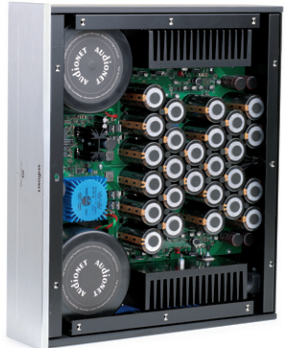
Das EPX bietet mehr als ein halbes Farad Speicherkapazität für den DNP.
